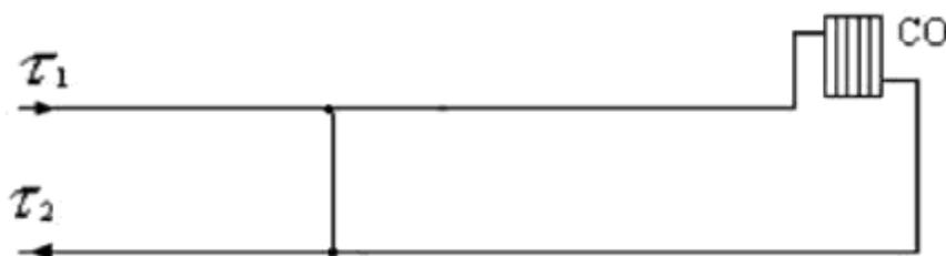
Рисунок 1.3.16.2 - Схема подключения потребителей к двухтрубной системе теплоснабжения
