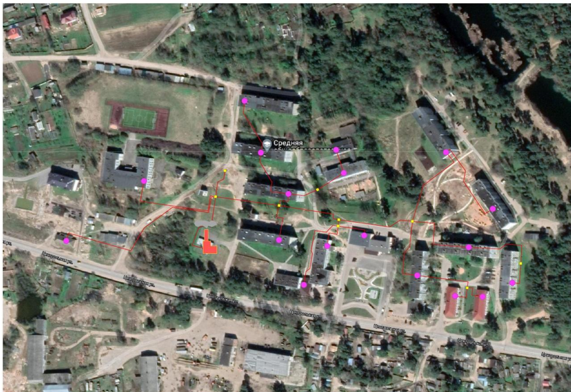
Рисунок 2 Схема теплоснабжения д. Ретюнь
