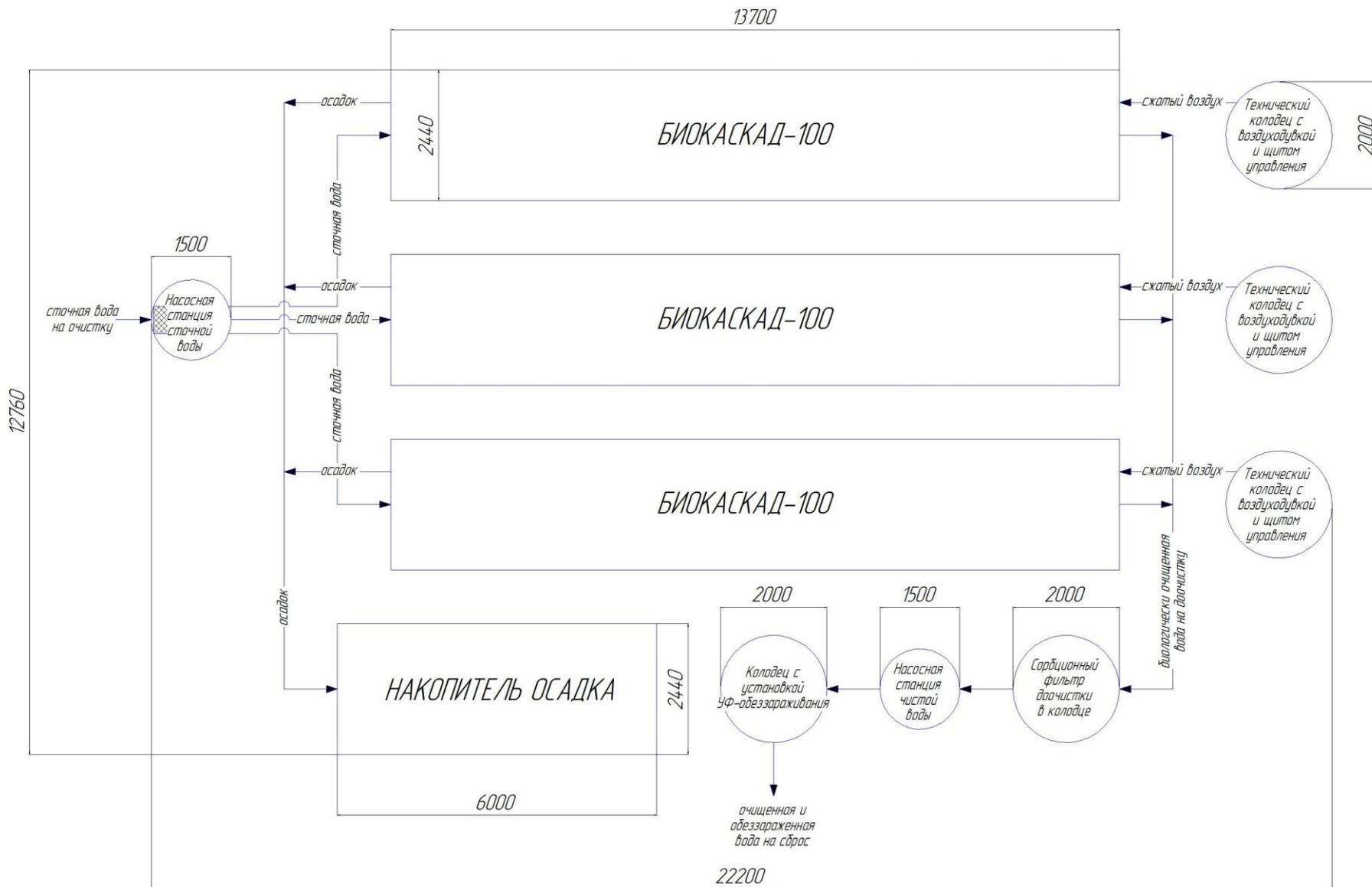
Рисунок 7 Технологический план очистных сооружений хозяйственно-бытовой канализации производительностью до 300 м<sup>3</sup>/сутки
