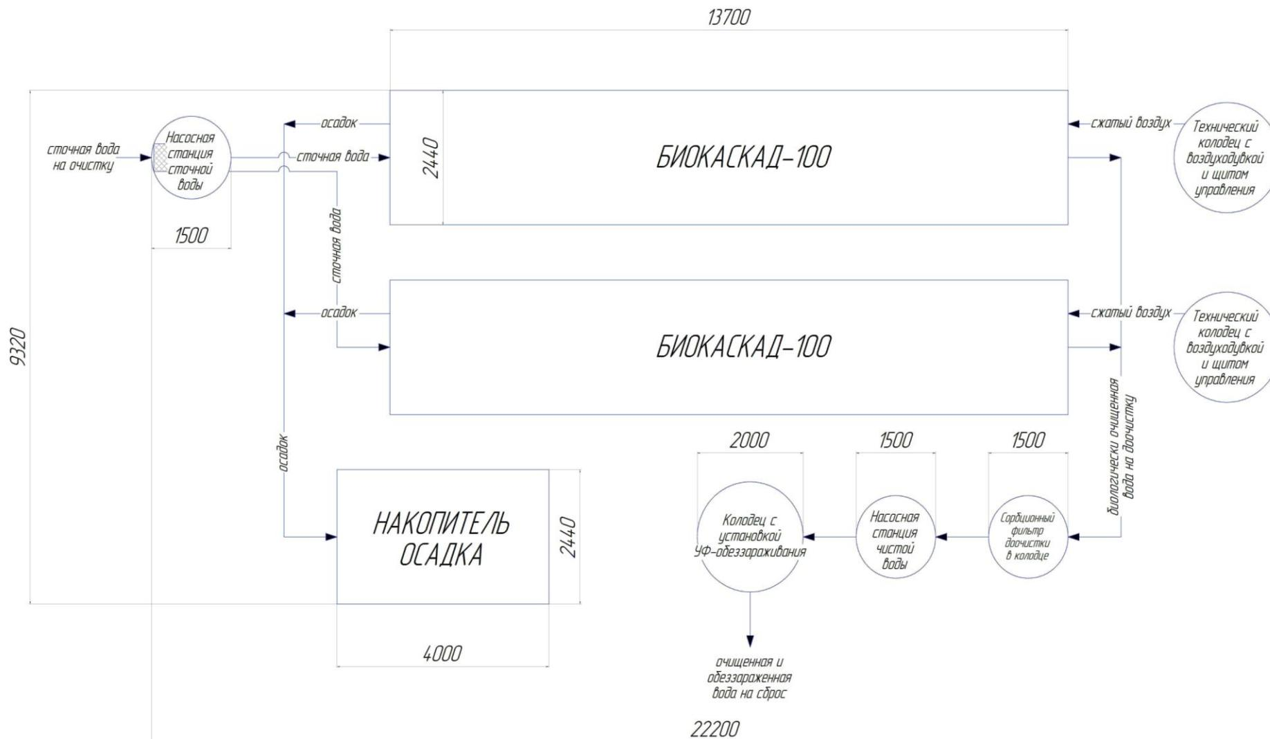
Рисунок 6 Технологический план очистных сооружений хозяйственно-бытовой канализации производительностью до 200 м<sup>3</sup>/сутки
