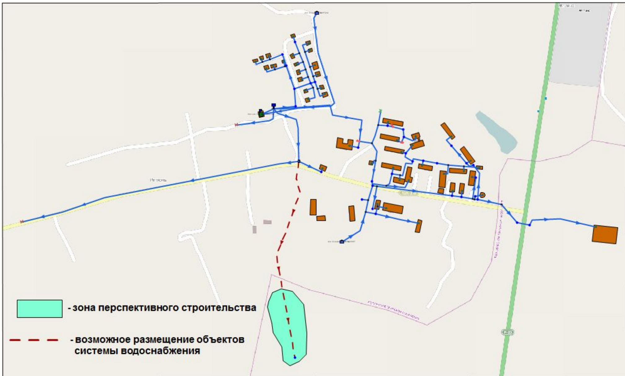
Рисунок 8 Схема водоснабжения д. Ретюнь
